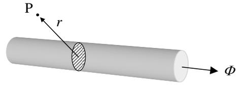
[解答] 発生する電界は、直線電流の周囲に発生する磁界のように、直線状磁性体棒の中心軸に関して軸対称となる。磁性体棒の中心軸からの距離 $r$ の電界を $E(r)$ とし、中心軸から等距離にある半径 $r$ の円周 $C$ に沿って、ファラデーの法則を適用する。
