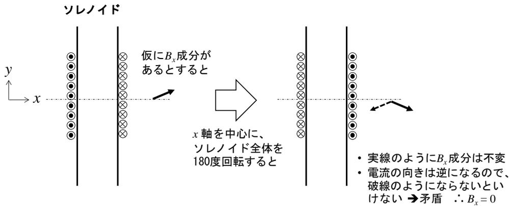
$\therefore$  「対称性により、無限長のソレノイドの内外で、 $\mathbf{B}$  は (少なくとも)  $y$  軸方向を向く」と言える。その結果、長方形の閉経路で周回積分した際、上下の辺 ( $x$  方向) の線積分を零としたのである。実際は、ソレノイドの外側では  $\mathbf{B} = 0$  となること、その後導される。
